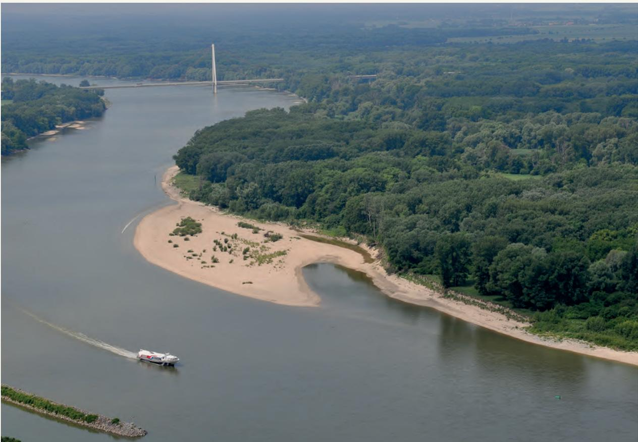
Abb.20: Hinter einer vorgelagerten Insel hat sich nach dem Uferrückbau ein Naturufer ausgebildet
